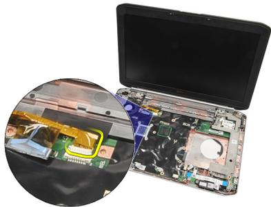
**14.** Tirare i cavi dell'antenna attraverso l'apertura della parte superiore del computer.
