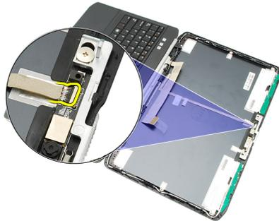
6. Allentare la vite che fissa il modulo della videocamera e del microfono.
