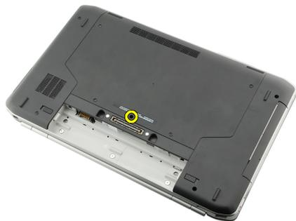
5. Capovolgere il computer e rimuovere le viti che fissano la tastiera alla parte anteriore del computer.
