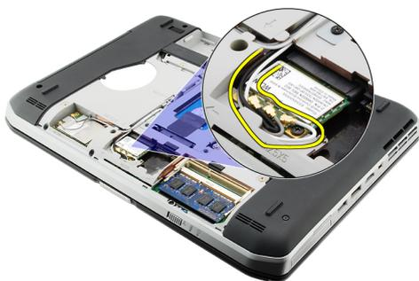
5. Rimuovere la vite di fissaggio della scheda WLAN alla scheda di sistema.
