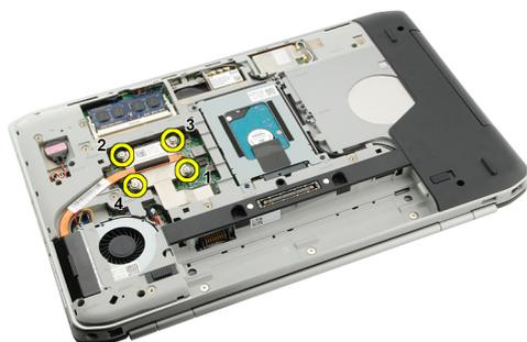
6. Sollevare il dissipatore di calore ed estrarlo dal computer.
